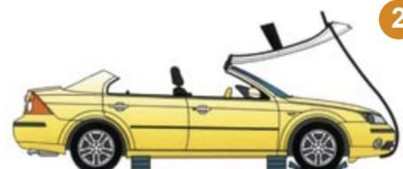
2 Теперь спасатели могут отклонять крышу вперёд. При этом может быть использован лом в качестве рычага. После отгибания крышу зафиксировать ремнём.
