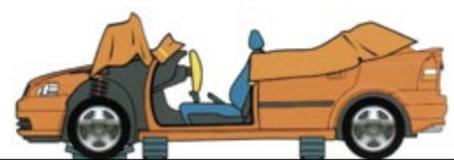
4 Необходимо убедиться, не мешают ли элементы отделки, такие как ремни безопасности или накладки, снятию крыши с автомобиля. После этого спасатели могут снять и перенести крышу в место для металлолома. По завершении работ укрыть все острые края обреза.
