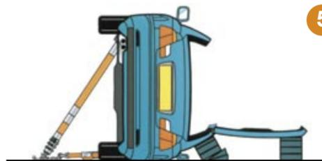
5 С целью устройства горизонтальной рабочей платформы необходимо вставить подпирание блоки в месте где будет лежать крыша. Теперь можно отгибать крышу вниз с осторожностью, чтобы не нарушить стабильность автомобиля.
