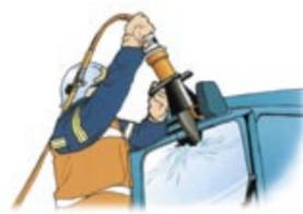
1 Выполнить разрез стойки А.
