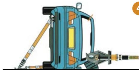
4 Выполнить резку в крыше над стойкой С. В некоторых автомобилях конструкция требует также среза в стойке А.
