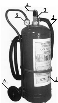
Рис. 4.4. Огнетушители порошковые ОП-50(з): корпус 1; шланг 2 с насадком; запорно-пусковое устройство с сифонной трубкой 3; рукоятка 4; манометр 5; колеса 6
