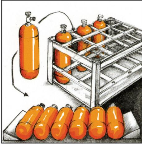
При хранении в специальной раме или на полу, баллоны должны быть надёжно закреплены.
